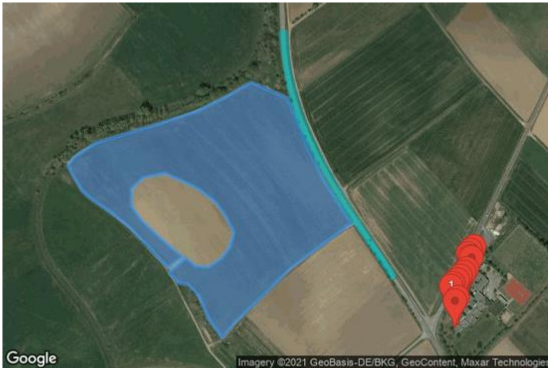
Abbildung 9 – Simulationsaufbau (blau – geplante Anlage, grün – Weg eines Fahrzeugs, rot – Beobachtungspunkte) - Quelle: SolarForge
